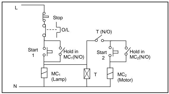
FIGURE 6.1: RELAY CONTROL CIRCUIT
