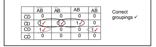
6.6.2  $Y = \overline{B} C D' + \overline{A} \overline{C} D' + B \overline{C} D'$ (3)
