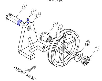
**EXPLODED ISOMETRIC DRAWING**
