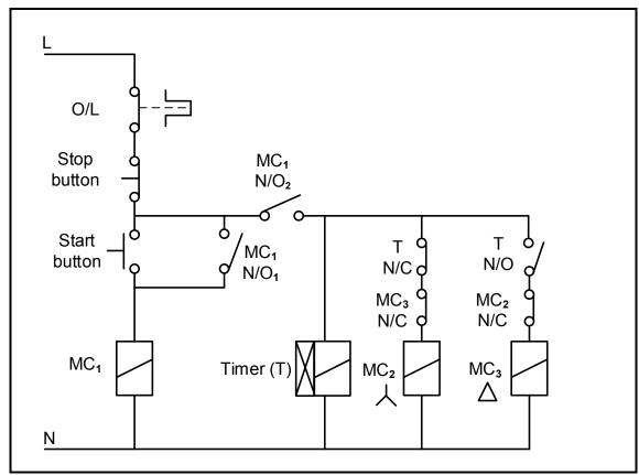
**FIGURE 6.10: CONTROL CIRCUIT**
