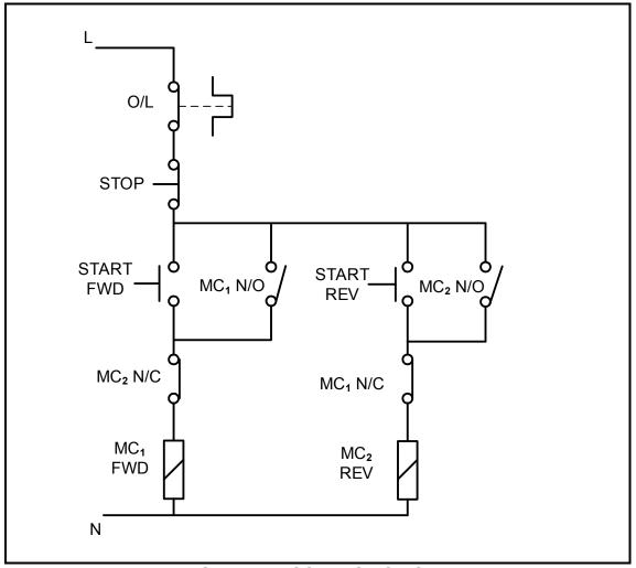
**FIGURE 5.5: CONTROL CIRCUIT**
