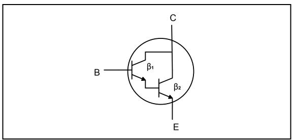
**FIGURE 3.5: TRANSISTOR**
