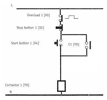
**FIGURE 9.1: DIRECT-ON-LINE STARTER**
